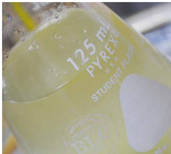
Ensayo exploratorio, precalentamiento del aceite antes de agregar el catalizador.
